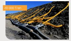
\* Biotraitement : Dépollution des terres souillées aux hydrocvarbures par traitement biologique
